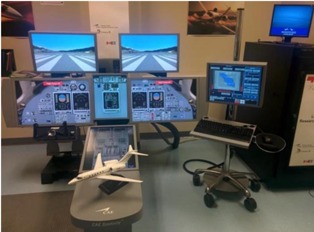
Figure 3 Simulateur de vol de recherche pour le Cessna Citation X Niveau D (RAFS)
