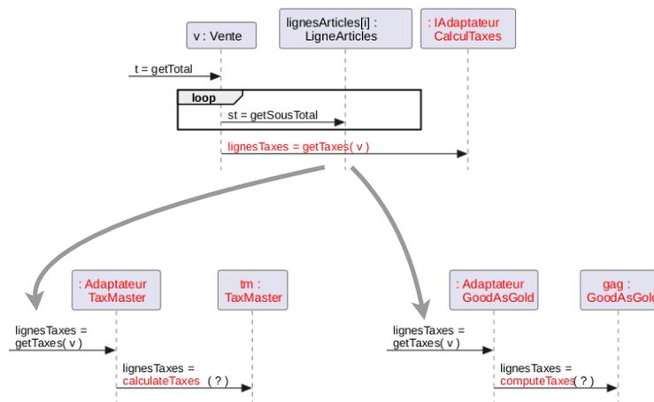
FIGURE 14.4. – Le mécanisme de Polymorphisme dans le pattern Adapteur appliqué au problème de calculateurs de taxes. `getTaxes(...)` est un appel polymorphe. Selon la configuration du système (l'objet auquel `IAdapteurCalculTaxes` fait référence), le comportement sera différent.
