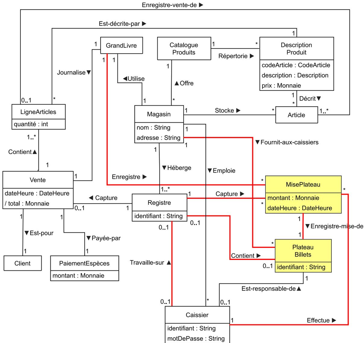
FIGURE C.2. – Modèle du domaine partiel pour le système NextGen POS présentant les différences par rapport au modèle du domaine de base présenté par Larman, avec l'ajout des classes conceptuelles *PlateauBillets* et *MisePlateau*, qui modélisent de nouveaux éléments du cas d'utilisation *Ouvrir la caisse*.
