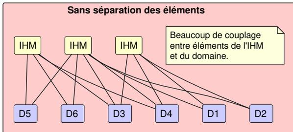
(a) Sans séparation, les éléments de l'IHM sont fortement couplés aux éléments de la logique de l'application. Ce genre de solution peut être créé rapidement. Cependant, si le code de l'IHM doit changer pour accommoder une nouvelle technologie, ces changements peuvent affecter le reste du système.
