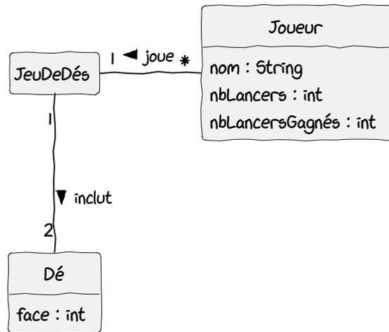
FIGURE 1.1. – Diagramme de *classes conceptuelles* décrivant (modélisant) le *problème* d'un jeu de dés (figure 1.3
