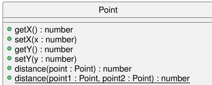
FIGURE 5.1. – Les méthodes publiques d'une classe sont un exemple d'interface API.
