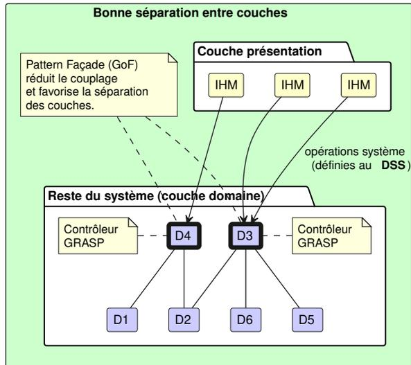
(b) La définition et la séparation des couches présentation et domaine permettent de minimiser l'impact des changements dus aux évolutions dans les technologies liées à l'IHM et d'avoir une conception plus cohésive. Cependant, cette séparation requiert un respect de l'architecture par les développeurs et développeuses.
