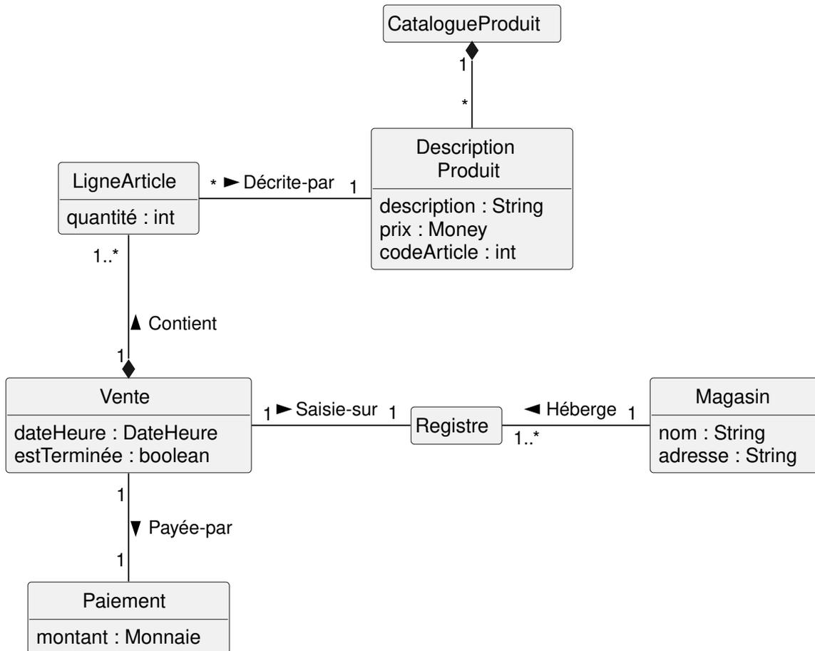
FIGURE B.2. – MDD pour le scénario *Traiter une vente* de Larman (2005).
