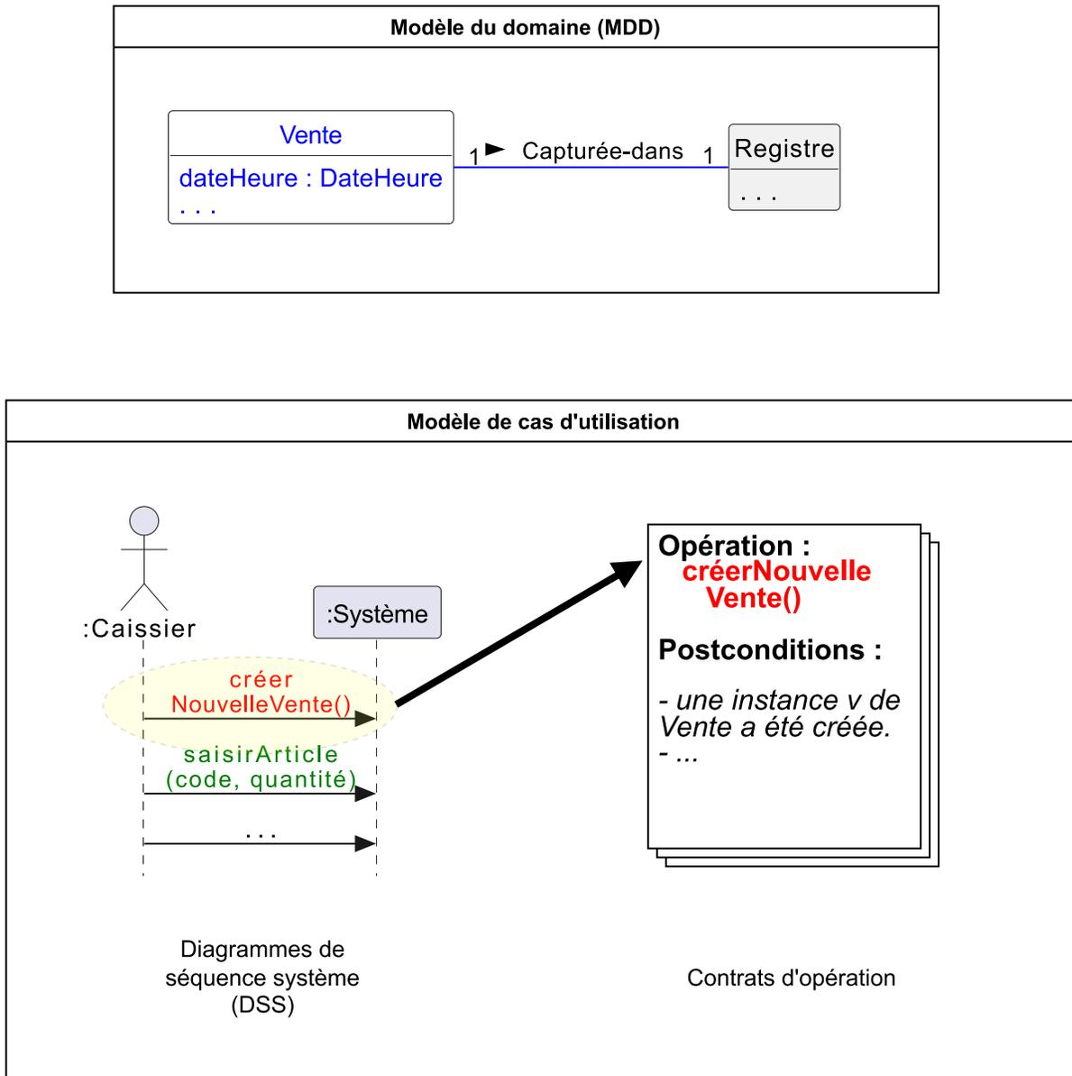
FIGURE 8.1. – Pendant l'opération système `créerNouvelleVente`, une instance de `Vente` doit être créée. Le contrat d'opération le spécifie dans une postcondition : une instance *v* de `Vente` a été créée.
