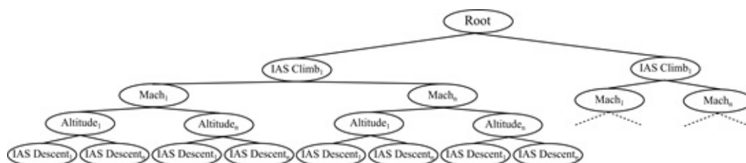
Figure 3. Le problème de trajectoire de référence verticale vu sous forme de graphique
