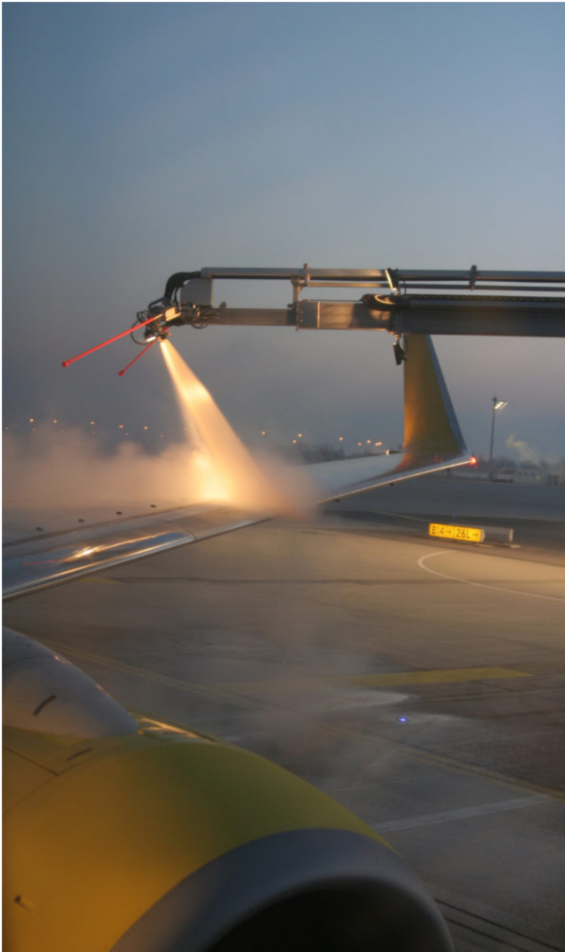
Figure 1 – Dégivrage au sol
