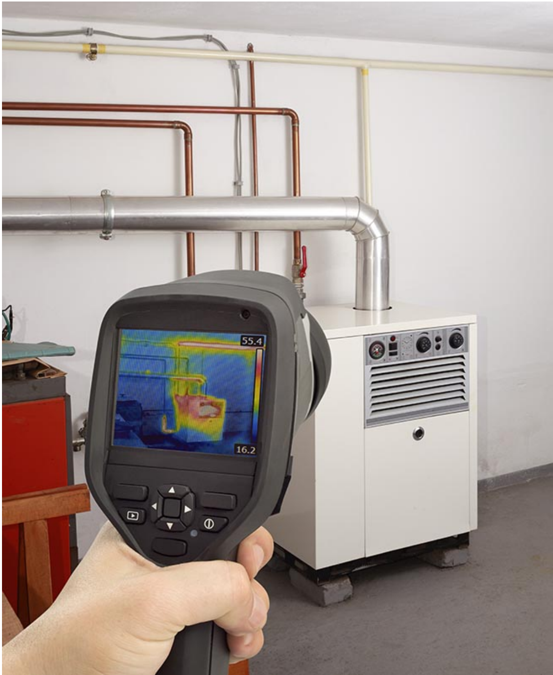
Figure 2 Exemple de mesure de température sans contact
